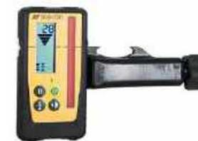
Le laser **fonctionne avec une cellule de réception**, placée sur une mire grâce à son support.
