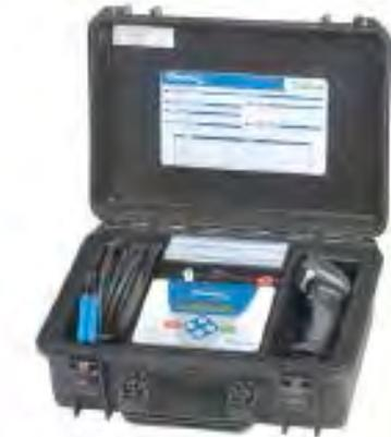
Machine à souder compacte ONDINE SE Ø 20 à 160 mm **Réf : ME573**
