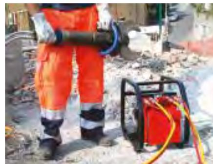
Groupe hydraulique électrique 2,2 kW HP 600 bar
