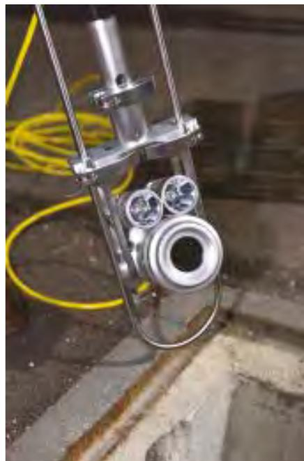
Caméra d'inspection pour regards avec mesure laser
