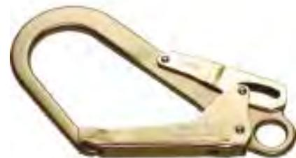
Connecteur à verrou M53 - ouverture 50 mm - Résistance 25 kN      Réf : **OR208**
