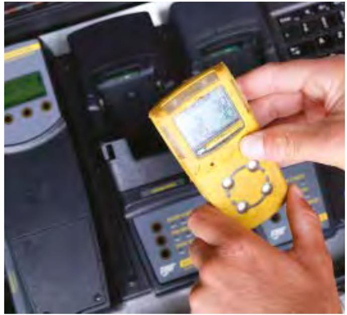
Valise volante d'étalonnage des détecteurs de gaz
