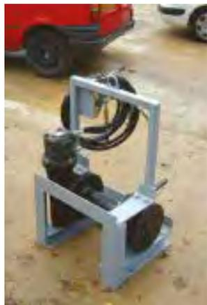
Chassis de fond de fouille pour treuil d'extraction pour plomb **Réf : AD536**
