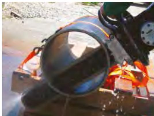
Tronçonneuse hydraulique à chaîne diamantée 45 cm **Réf : CT353**
