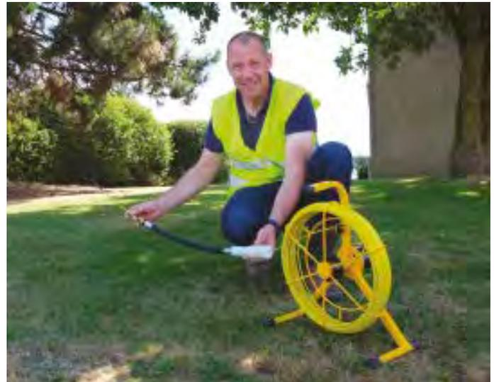
Aiguille détectable avec presse-étoupe pour eau et gaz Réf : AD311
